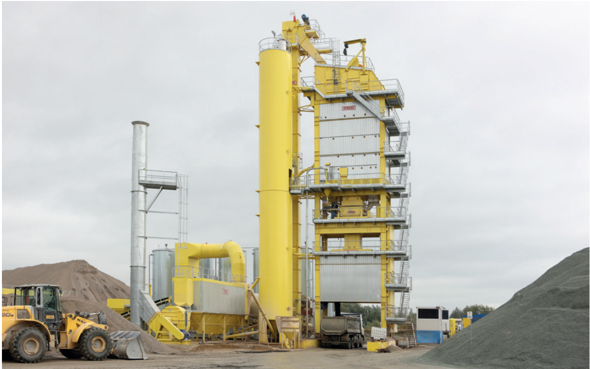
Planta asfáltica de 320 t/h (Polonia). Con torre mezcladora InNOVA-G. Con tolvas en caliente de 160 t y silo de aglomerado de 81 t. Mezclador de 4.500 kg.
