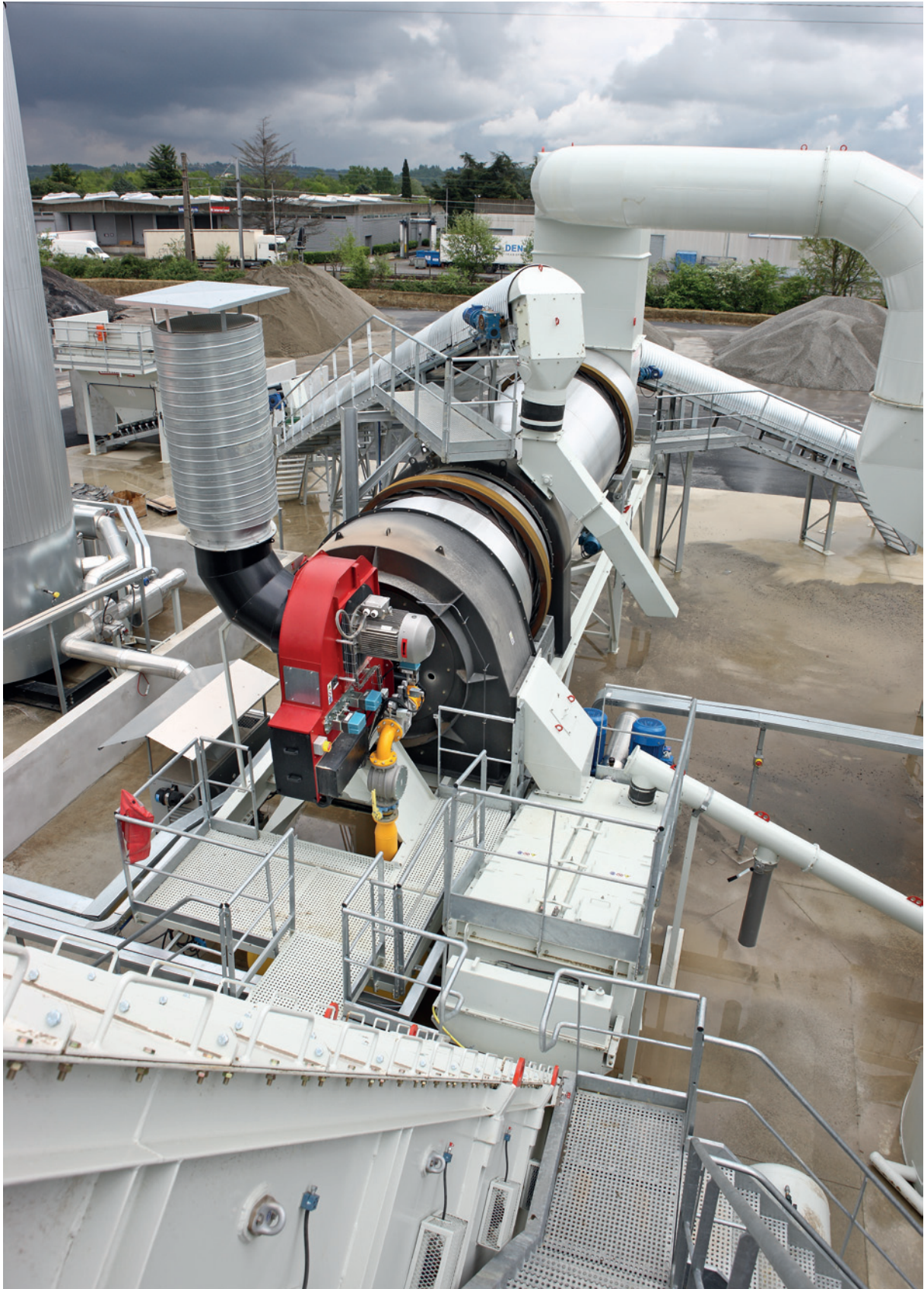
Secadero y mezclador de planta asfáltica continua Flow-Mix 220.
