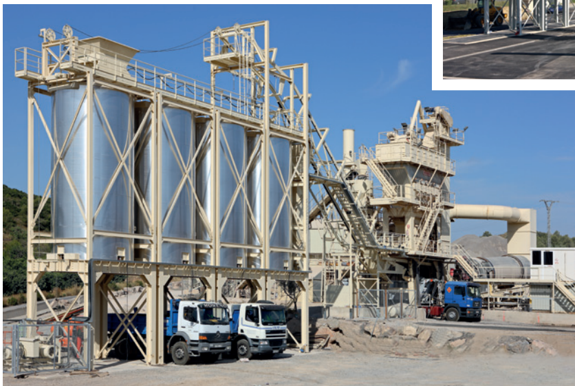
Batería de cuatro silos de 85 t cargados mediante vagoneta con desplazamiento horizontal que a su vez recoge el aglomerado del mezclador mediante una vagoneta elevadora. Cada silo dispone de sistema de pesado para controlar la carga de los camiones.
