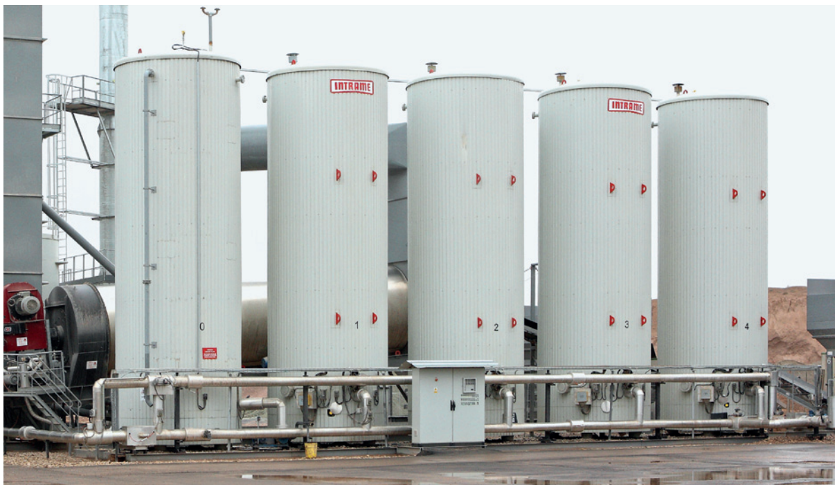
Parque de ligantes con calentamiento eléctrico en planta InNOVA 320 (Polonia).
