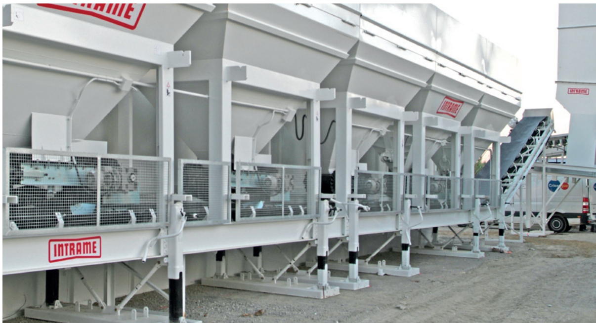
Detalle de las placas de apoyo de las tolvas.
