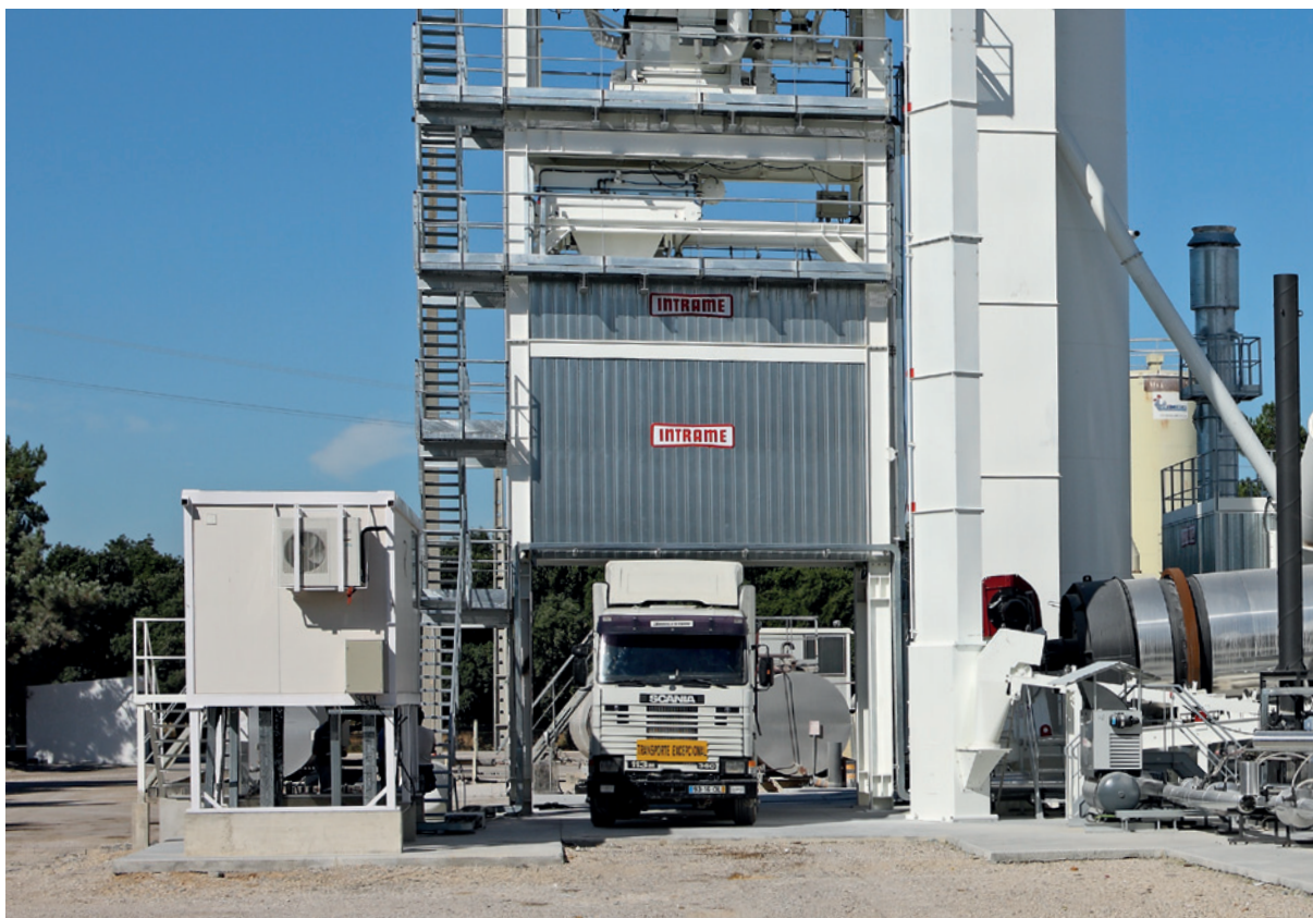
Planta con silo debajo del mezclador. Descarga por gravedad sobre vagoneta con movimiento horizontal, lo que permite emplazar silos adicionales.
