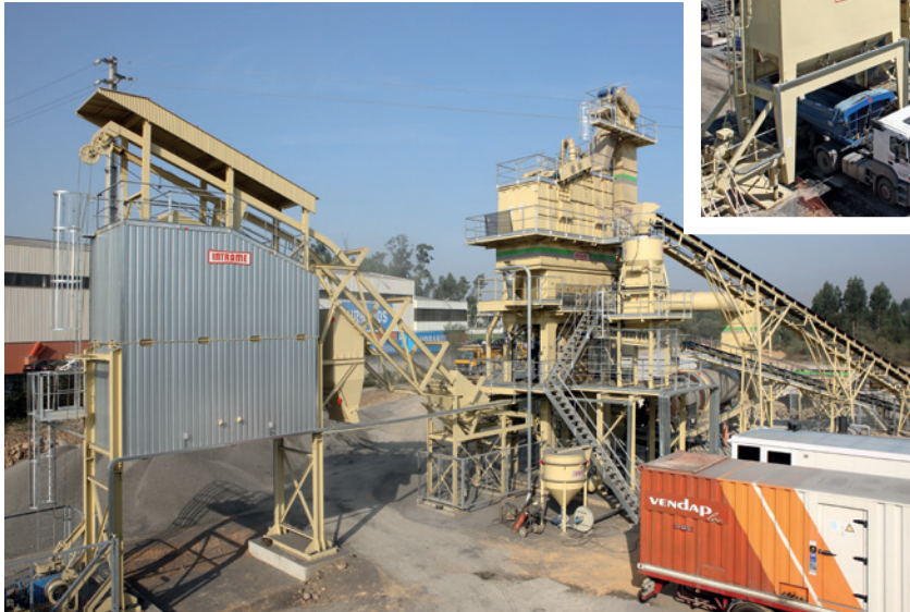
Silo de 100 t instalado en una planta asfáltica M-280.
