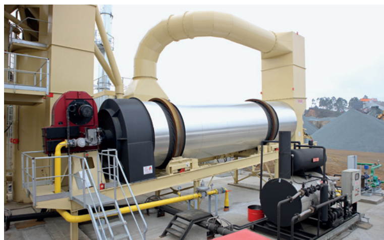
Secadero de RM-280. De gran rendimiento. Provisto con quemador de alta eficiencia que cumple con las leyes internacionales más estrictas relacionadas con el medio ambiente. También en primera plana se muestra la caldera de aceite térmico de alta eficiencia energética.
