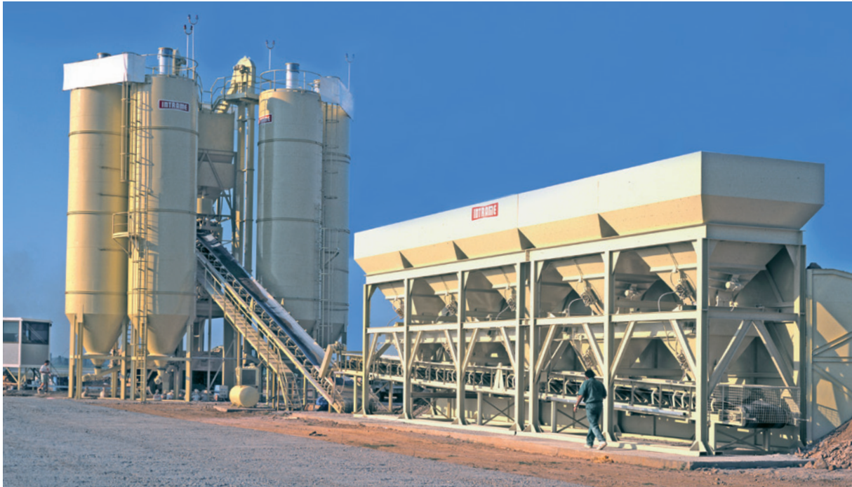
Planta de hormigonado PH-150 con amasadora forzada de doble eje horizontal de 3 m 3 (aeropuerto de Barcelona).
