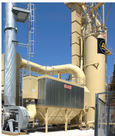
Vista del filtro de mangas y del doble silo de polvo recuperado y de filler de aportación en una RM-280.
