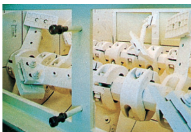
Mezclador de paletas de doble eje. Diseñado para bajo consumo de potencia y pequeños desgastes. Calefactado por aceite caliente. Elementos de desgaste de gran resistencia. Provisto de puertas laterales de acceso para sustitución cómoda de palas, etc.
