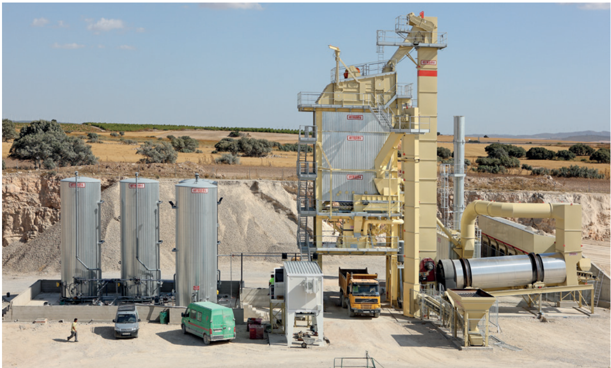
Planta asfáltica de 280 t/h (España). Con torre mezcladora InNOVA-G. Con tolvas en caliente de 160 t. Tanques de asfalto y fuel con calentamiento eléctrico. Mezclador de 4.000 kg. Provista de sistema de reciclado en frío con descarga en el mezclador.
